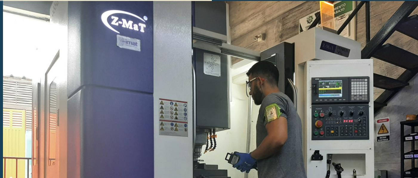
Son los más adecuados para realizar operaciones en superficies planas con cavidades hondas. Un ejemplo es la fabricación de matrices, moldes o dados. Estas máquinas ofrecen una gran rigidez y producen piezas con buena precisión dimensional.
