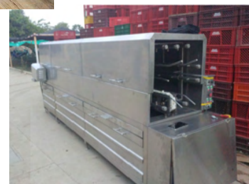
FABRICACION Y MONTAJE DE BANDA LAVADORA DE HUACALES
